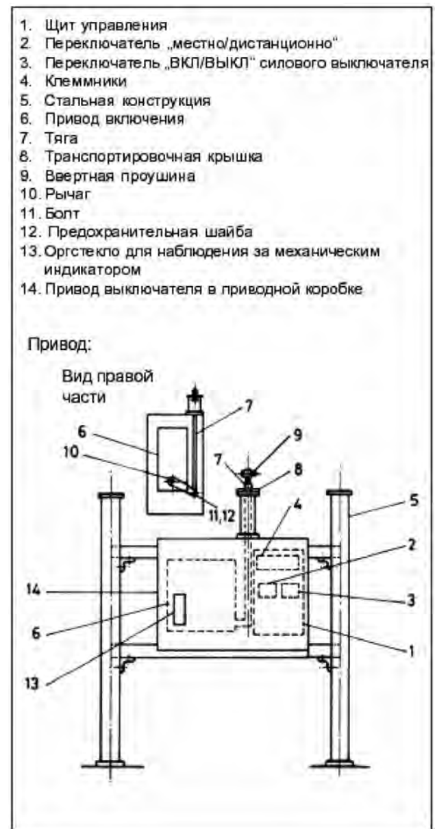
Рис. 10. Стальная конструкция для привода и щитка управления
