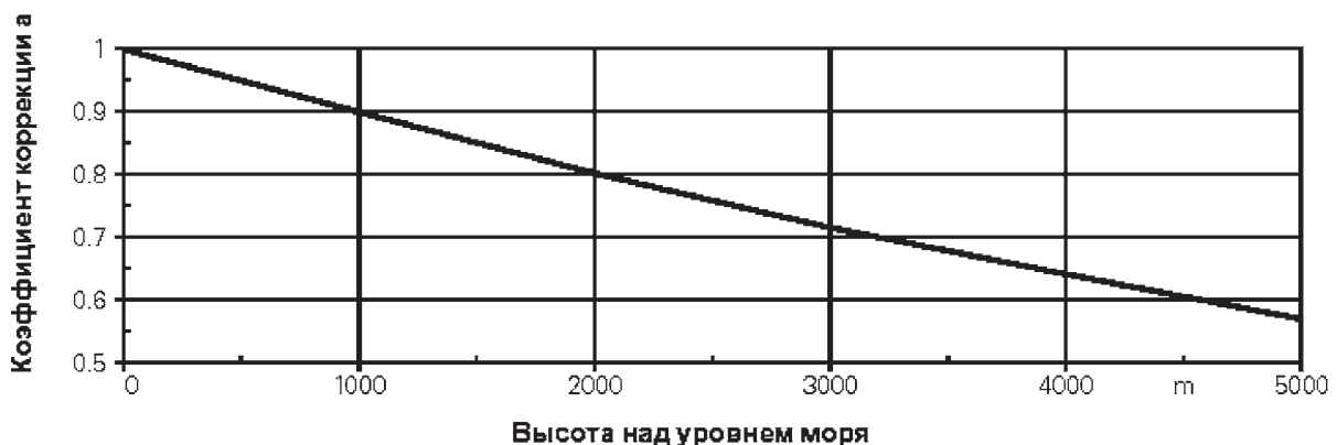
Рис. 3. Коэффициент коррекции в зависимости от высоты монтажа
